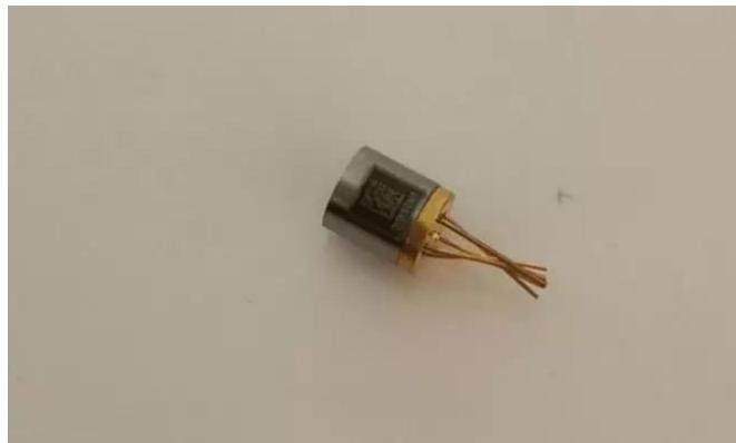
圆柱形状的组件直径 6mm,弧面上二维码尺寸为 2\*3mm
